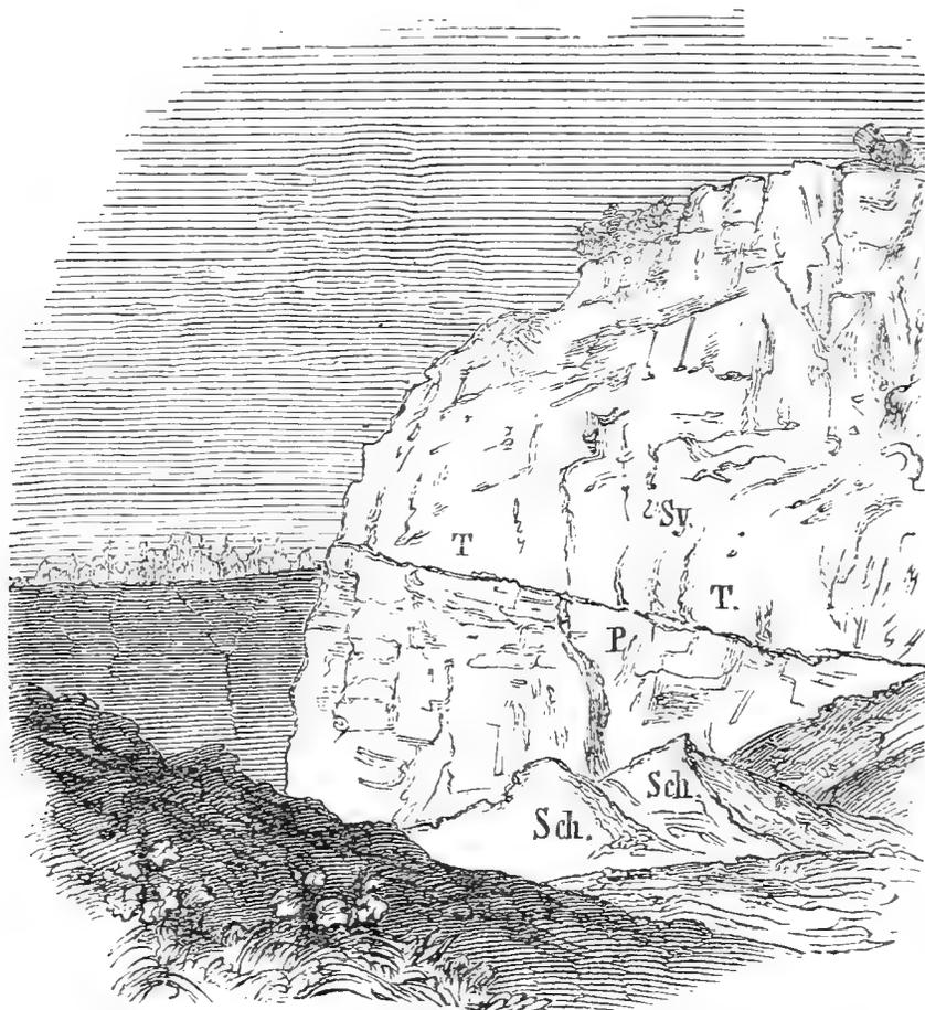
Fig. 56. Steinbruch bei Weinböhlen, frei nach Caru: Sy. Syenit. T. Thon- und Mergelschicht. P. Plänerkalkstein. Sch. Schutt.
