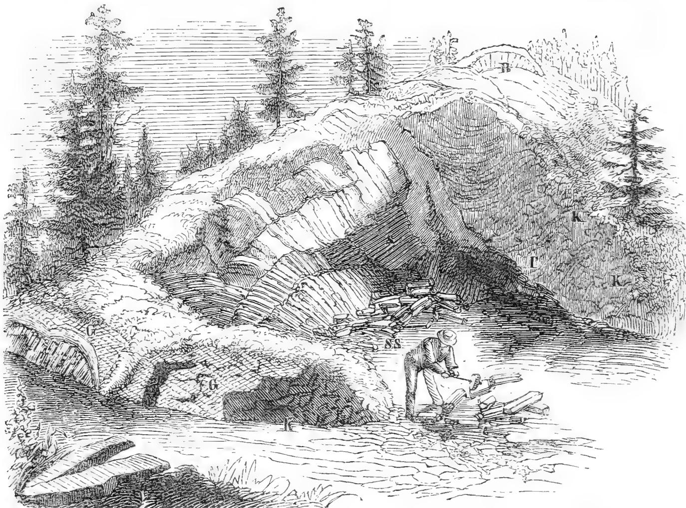
Fig. 53. Basaltbruch am Pinzenberge. B. Säulen am Giesel. S. Säulenbasalt. P. Plattenbasalt. K. Basaltkonglomerat. SS. Losgebrochene Säulen. G. Granit.
