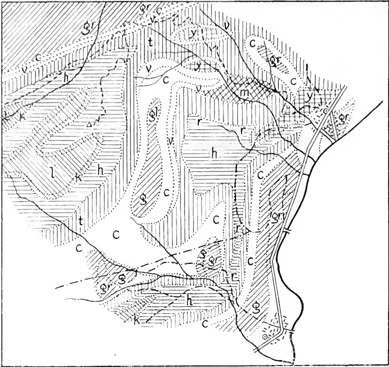
Fig. 43. l Lias, k Koessener, h Hauptdolomit, r Raibler, t Triasglieder, m Muschelkalk, v Verrucano, y Gips, c Casannaschiefer, gl Glimmerschiefer, g Gneiss, gr Granit.
