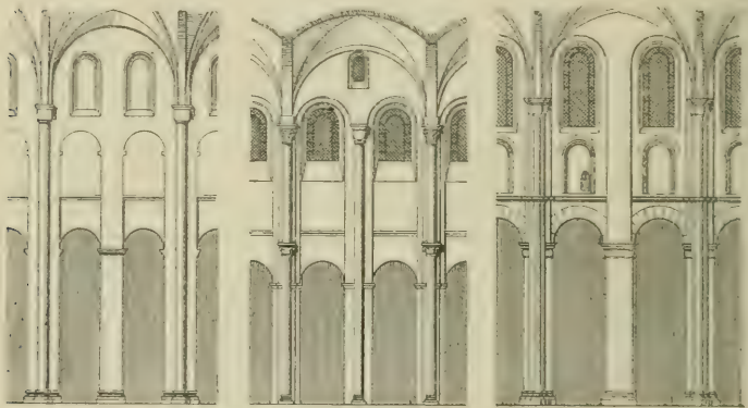
Fig. 55. Schematische Zusammenstellung der Apsidenbauten in Mainz, Speier und Worms.
