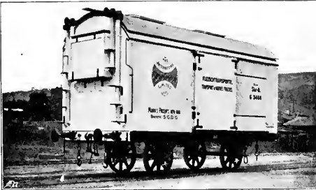
Abb. 358. Fleischtransport-Wagen [System Mann.] [1885]
