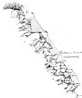
Abb. 84. Type für Steinschlag-Verbauungen. [Arlbergbahn.]
