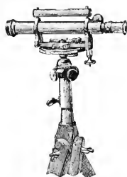
Abb. 43. Stampfer'sches Nivellir- und Höhenmess-Instrument.
