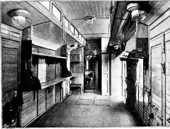
Abb. 354. Gepäckraum eines vierachsigen Postwagens. [1875]
