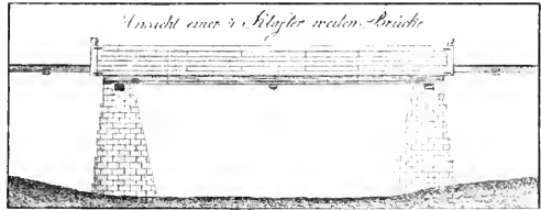
Abb. 135. Klötzeholzbrücke der Linz-Budweiser Pferdebahn.
