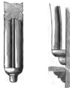
Fig. 286. Gewölbegurte zu Pechüle.
