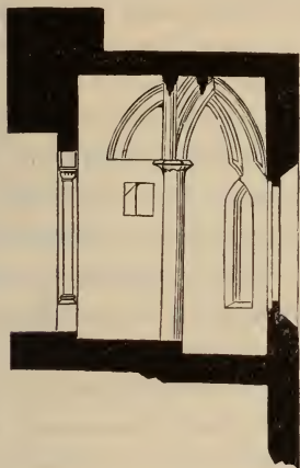
44. Durchschnitt des südlichen Stiegenhauses im Preßburger Dome.
