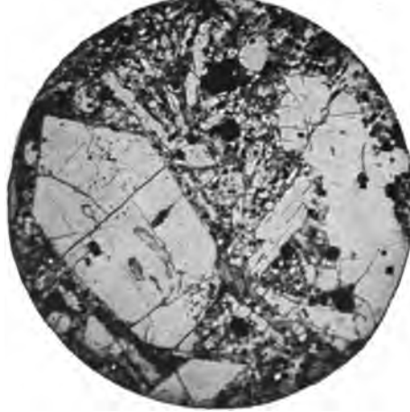
Fig. 306. Mellilithbasalt. Hochbohl (Schwäbische Alb). Links großer Olivin; helle Leisten Mellilith; rechts unten am Olivin Augit; dunkle Erzdurchschnitte
