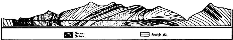
Fig. 443. Geologisches Profil längs der Achse des Simplontunnels. Nach C. Schmitt und H. Prellwerk.
