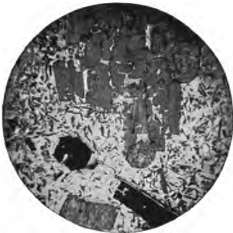
Fig. 269. Minette. Freiberg (Sachsen). Lappiger Glimmer, Mitte rechts unten Augitpseudomorphose. Glimmerblättchen in heller Feldspatgrundmasse.
