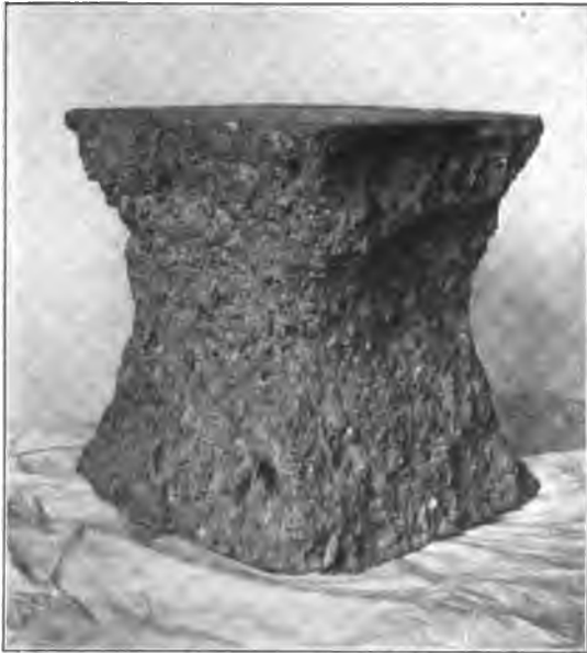
Fig. 200. Betonwürfel nach dem Druckversuch.
