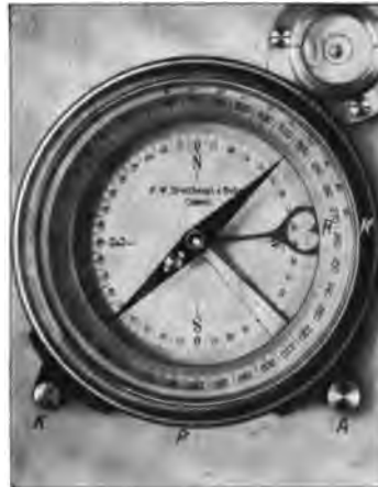
Fig. 60. Bergmännischer Kompaß nach A. Helm. (Bezugsquelle F. W. Breithaupt u. Sohn, Kassel).
