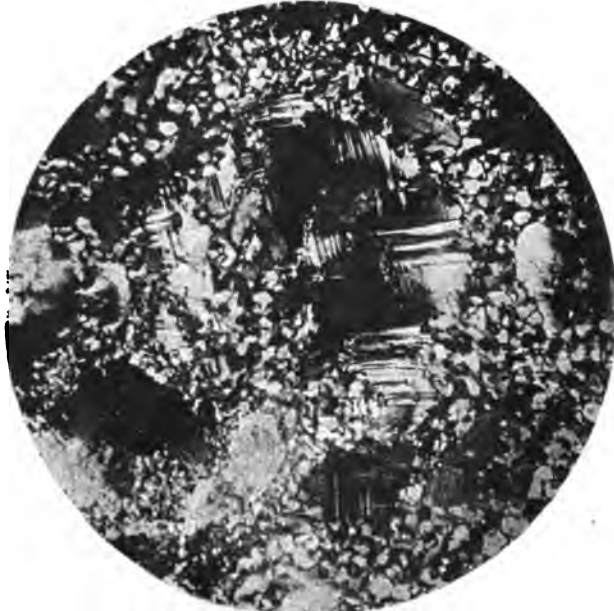
Fig. 150. Durch Gebirgsdruck innerlich zermalmtter Gabbro von Penig (Sachsen).
