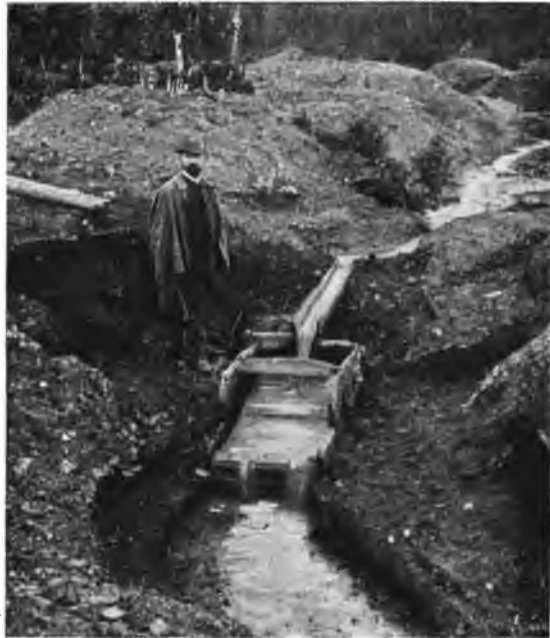
Fig. 354. Lose Trümmernmassen einer Platinseife bei Solowiw (Ural). In der Bildmitte eine kleine Platinwaschanlage.
