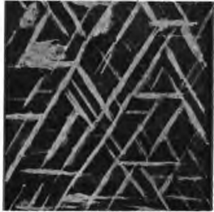
Fig. 319. Ferrit (hell) mit Oktaederstruktur und Perlit (dunkel) als Fülle in technischem Eisen. Nach Osmond. Vergr. 1:85.
