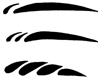
Abb. 10. Tragfläche von Lachmann und Handley Page.
