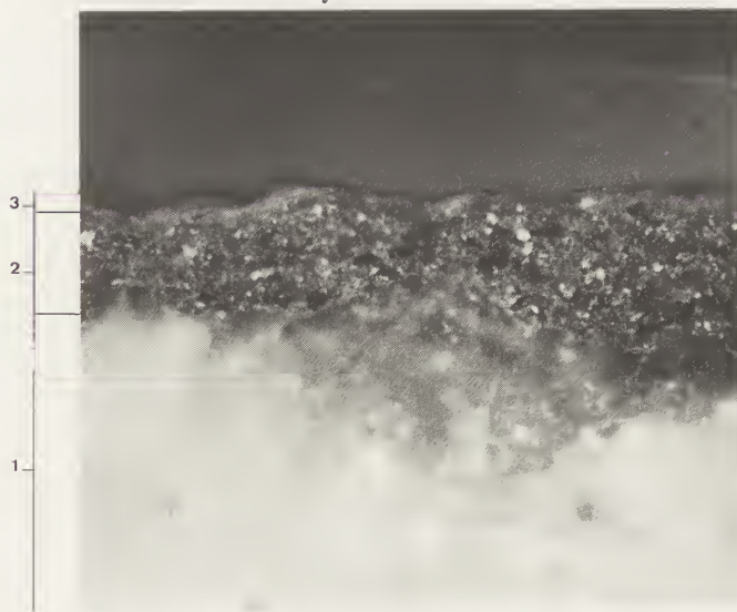
Photo n° 12 Coupe stratigraphique de SEF.82.16 1 : couche blanche (quartz) 2 : couche rouge-orangé (ocre rouge) 3 : couche brunâtre (sulfate)
