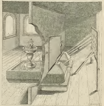
Fig. 2. Otra máquina de Salomón de Caus para elevar el agua por la acción del calor solar
