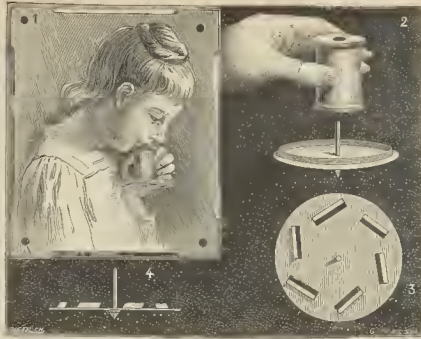
Trompo de fácil construcción. - 1. Vista del trompo en conjunto. 2, 3 y 4 Detalles de la construcción
