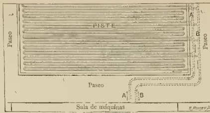
Fig. 3. Esquema de los tubos de congelación dispuestos en la pista de la sala de patinar en el Polo Norte , en París A. Tubo de entrada del líquido frigorífico. — B. Tubo de salida
