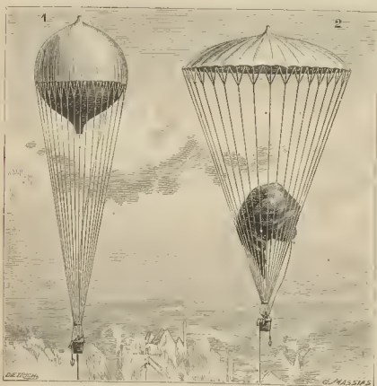
Fig. 2. El aerostato de M. Capazza con su paracaídas red: 1, El aerostato en el espacio; 2, El aerostato deshinchado y funcionamiento del paracaídas
