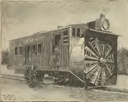
Fig. 1. Vista en conjunto de la nueva quitanieve americana Rotary
