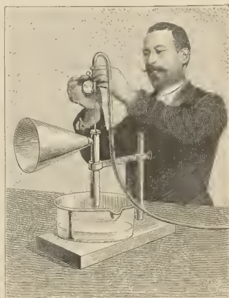
Fig. 5. Micrófono hidráulico de Mr. Chichester Bell.
