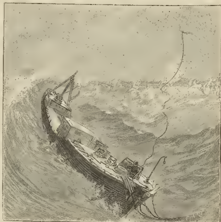
Fig. 2. Buque desmantelado puesto en comunicación con la costa por medio de una cometa
