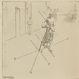
Fig. 3. Esquema de una bicicleta en el acto de virar. Primer fase de las figs. 1 y 2
