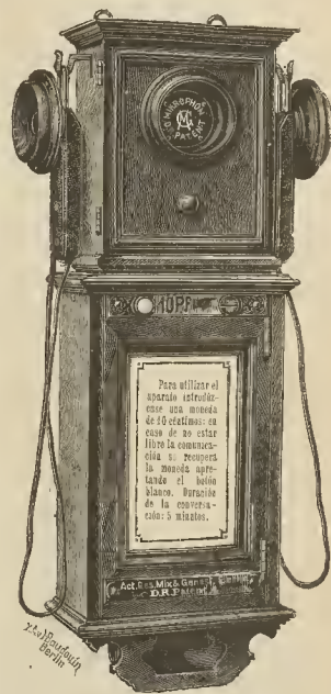
Teléfono automático visto exteriormente
