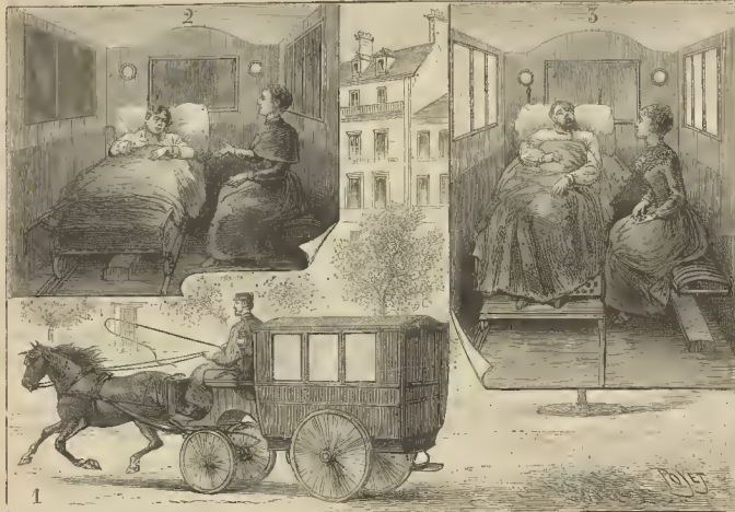
Fig. 1. Coche de las nuevas estaciones de ambulancias de París para la conducción de los enfermos 1. Vista del coche en conjunto. - 2. Vista del interior del coche. Detalle de las parihuelas en forma de cama. 3. Parihuelas en forma de sillón
