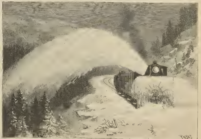
Fig. 3. La quitanieve Rotary funcionando. (De una fotografía instantánea.)
