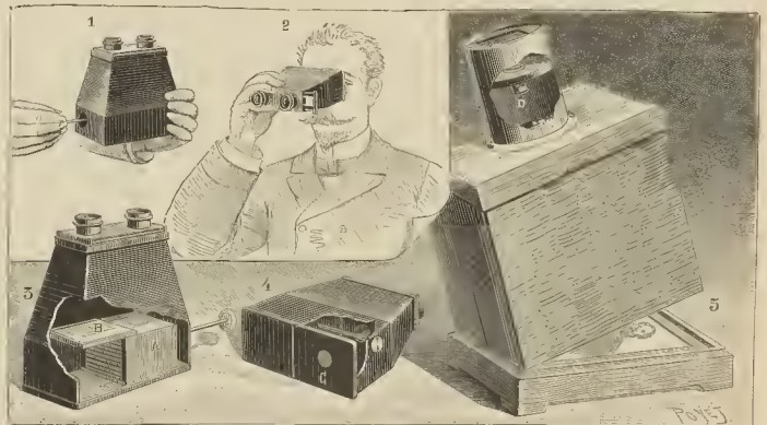
Gemelos fotográficos de M. J. Carpentier (núms. 1, 2, 3 y 4) y aparato para ampliar las pruebas (n.º 5)
