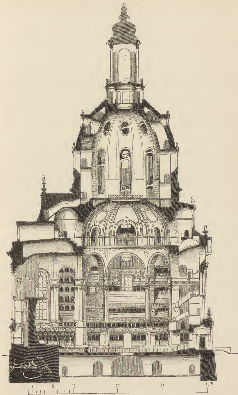
Fig. 31. Frauenkirche zu Dresden. Längschnitt.
