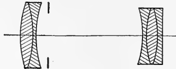
FIG. 53.—Zeiss Magnar 3\times , f/10 .
