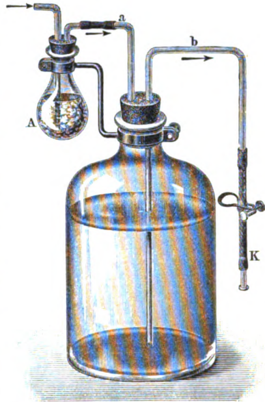
Fig. 3. Flasche mit Barytlösung mit Vorlage zur Entkohlensäuerung der eindringenden Luft.
