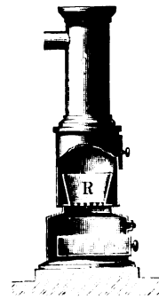
Fig. 62. Verbesserter Kanonenofen mit Rosteinsatz R.
