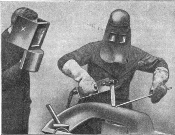
Fig. 6a. Beobachtungshandblenden bei elektrischen Schweißarbeiten. A. E. G.
