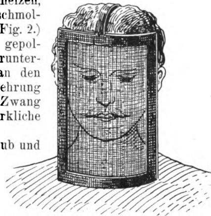
Fig. 2. Schutzgitter gegen gröbere Splitter.
