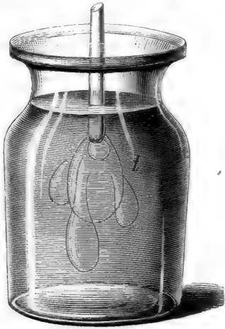
FIG. 3. Apparat zur Herstellung der TRAUBE'schen Zelle.
