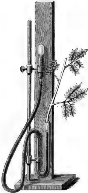
FIG. 278. Eine Mimosenpflanze am Manometer.
