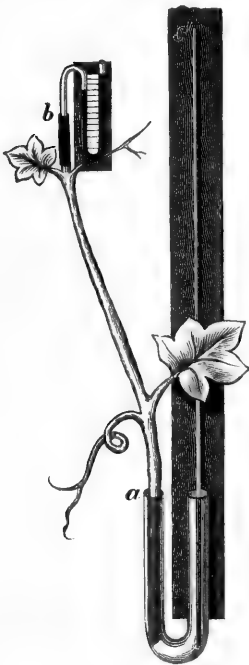
FIG. 411. Eine Weinrebe mit mehreren Blättern ist am oberen Ende abgechnitten und steht mit einem Manometer in Verbindung. Der untere Abschnitt bei a steht ebenfalls mit Wasser in dem U-Rohr in Verbindung, welches unter Quecksilberdruck durch den Sproß gepreßt werden kann.
