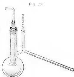
Destillierkolben nach Dohle.
