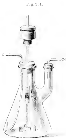
Rühren unter gleichzeitigem Gaseinleiten.
