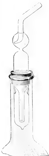
Kjeldahl-Aufsatz nach Dudy.
