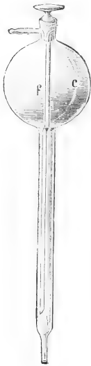
Selbsttätiger Nachfüll- apparat nach Schirm.
