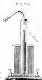
Fig. 250. Ventil des elektromagnetischen Thermoregulators nach Hahn .
