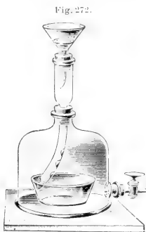
Fig. 272. Filtriervorrichtung für die quantitative Analyse nach Murmann .
