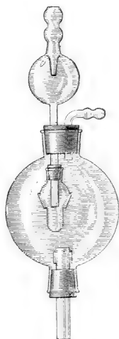
Wasserstrahlgebläse nach Mittelbach.
