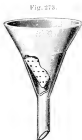
Fig. 273. Absaugtrichter aus Porzellan nach Meysahn .
