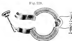
Elektromagnet zum Rühren nach Beckmann.
