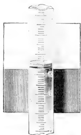
Mohr'sche Vorrichtung zum Ablesen von Büretten.
