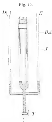
Anordnung der 7 Kapillarröhren des Whatmoughschen Apparates.
