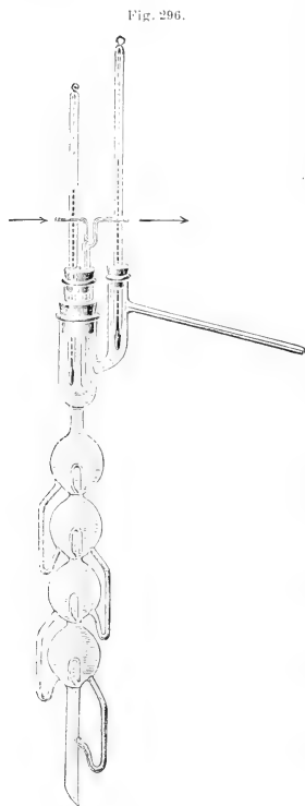
Fraktionieraufsatz nach Baum.
