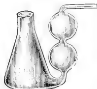
Absorptionsvorlage nach Fresenius .
