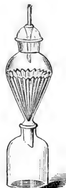
Apparat zur Extraktion fester Körper und zum Auswaschen von Niederschlägen auf dem Filter nach Gerber .
