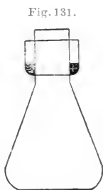
Erlenmeyer -Kolben mit Quecksilberrinne nach Sy .
