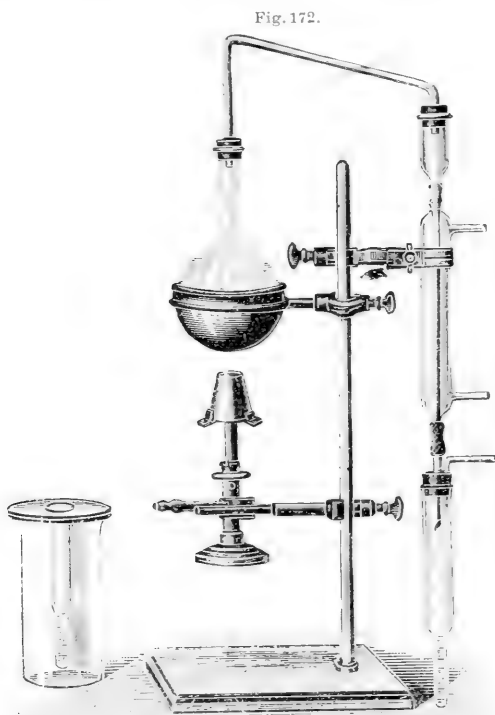
Apparat zur Wasserbestimmung in festen Körpern und Flüssigkeiten nach Marcussen.
