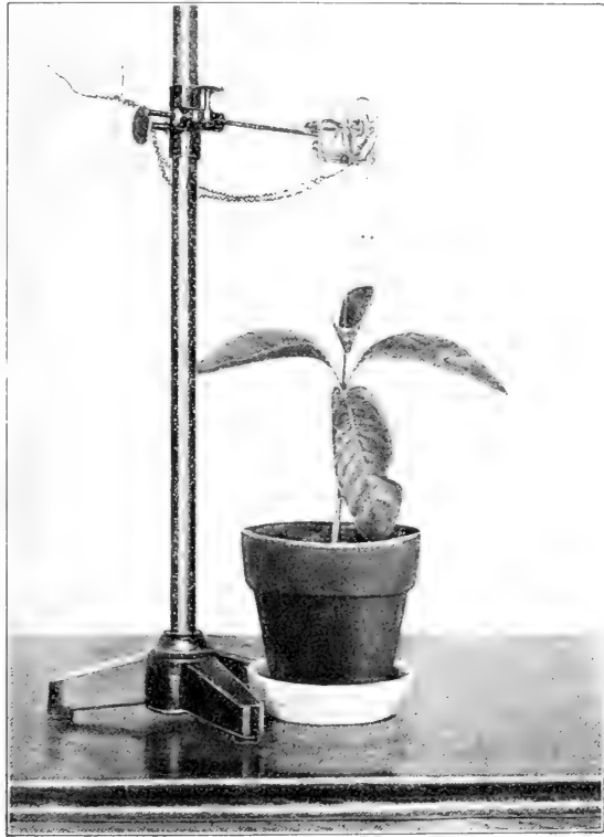
Auxanometer nach Frost.
