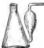
Absorptionsvorlagen nach Volhard .
