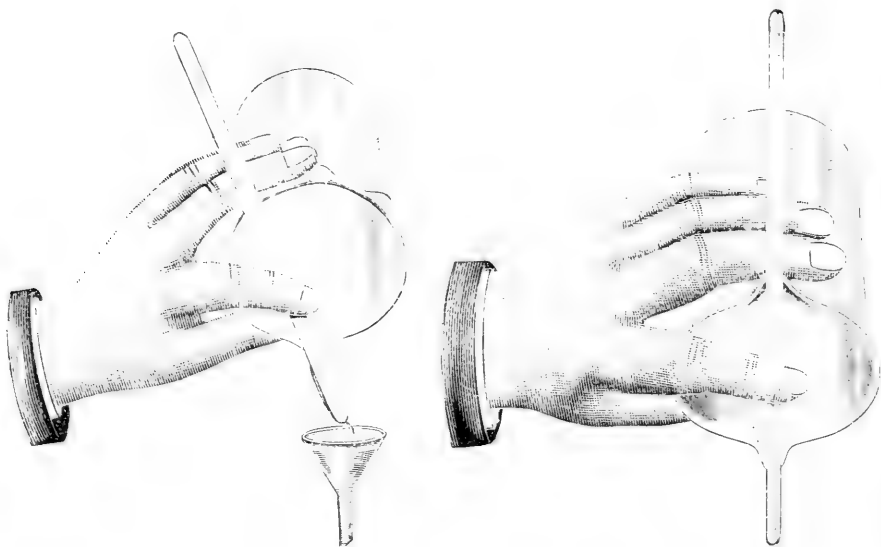
Bechergläser mit Auflagerinne für den Glasstab nach Kersten .
