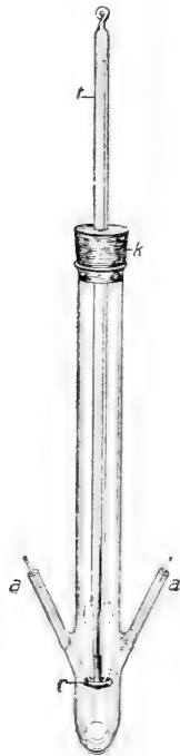
Schmelzpunktbestimmungsapparat nach Anthes.
