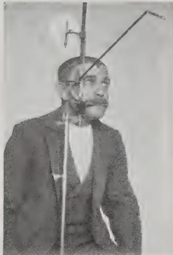
Apparat zur Bestimmung des Zitterfeldes und des Einflusses der Kopfhaltung.
