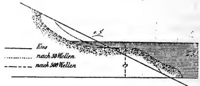
Abtragung eines Kiesstrands durch die Brandung bei seichtem Wasser (nach Hagen)
