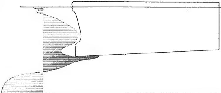
Anordnung der Stromrichtung und -stärke (vgl. Fig. 146) an einem schmelzenden Eisblock. Nach J. W. Sandström.
