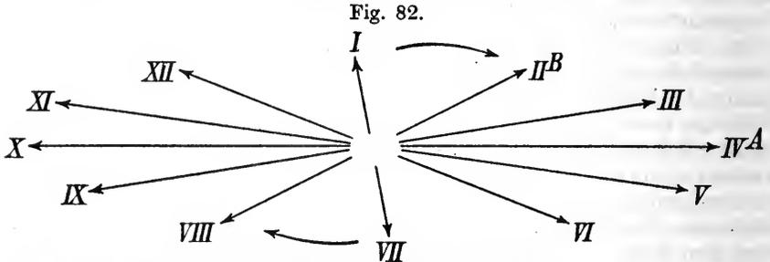
Drehstrom aus Interferenz zweier ungleich hoher Wellen mit schrägem Schnittwinkel ( $80^\circ$ ).
