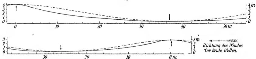
Zwei Profile von Hochseewellen nach photogrammetrischen Aufnahmen an Bord S. M. S. „Planet“
