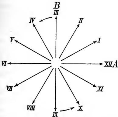
Drehstrom aus Interferenz zweier gleicher Wellen. Schnittwinkel  $90^\circ$ .
