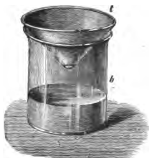
Fig. 160. Becherglas b mit einer Lösung des Fuselöls in Aether, zu \frac{1}{4} angefüllt. t Trichter ohne Abflussrohr als Verschluss dienend, welcher die Verdunstung des Aethers zulässt, die des Amylalkohols aber verhindert.
