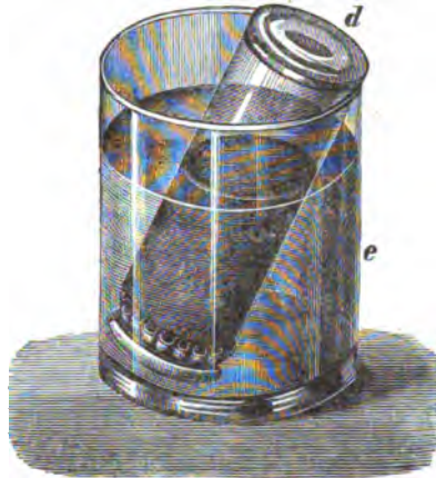
Fig. 66. Einfacher dialytischer Apparat. c Dialysator. e Exarysator.
