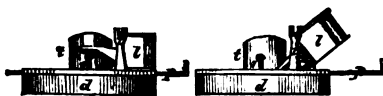
Fig. 128. Oellämpchen an ABEL's Apparat. l Lampe, p Schieber geschlossen (links), geöffnet (rechts), d Deckel des Petrolgefässes, g Perle, Maass für das Flämmchen.
