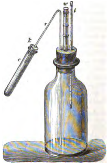
Fig. 124. Vorrichtung zur Bestimmung der bei niedrigen Wärmegraden gasigen Kohlenwasserstoffe. t Thermometer, r Glasrohr, w weites und kurzes Glasrohr, k Kork, c Reagircylinder.
