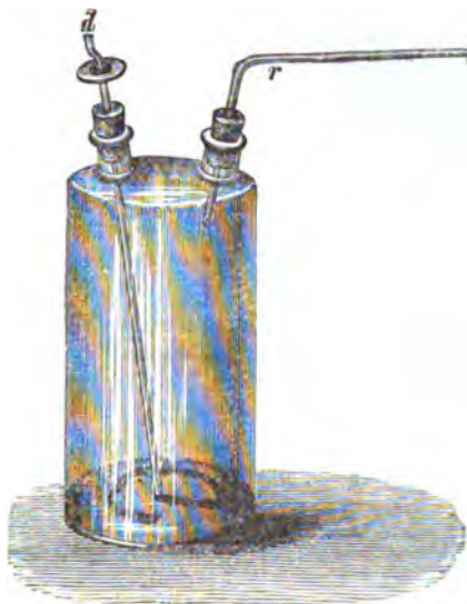
Fig. 10. Schwefelkohlenstofflampe, d Docht und Blechrohr, r offenes Glasrohr.
