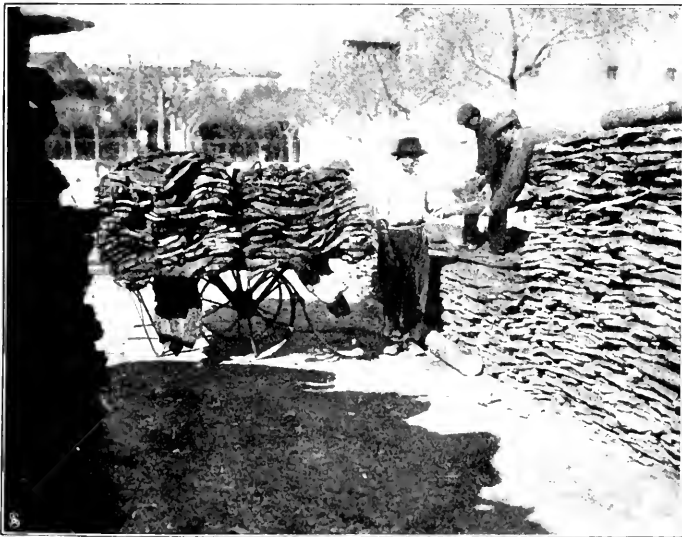
Fig. 90. Aufstapeln der Kork -platten zum Platten-, d. h. Geradestrecken
