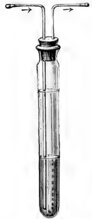
Fig. 74. Gelatine-Röhrchen für Luftuntersuchung nach HUEPPE. — Ca. ein Drittel der nat. Größe.
