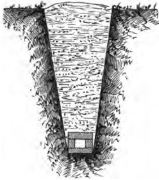
Steindrain aus Ziegelsteinen mit Sohlplatte.
