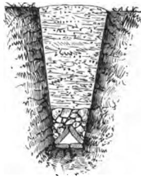
Steindrain von dreieckigem Querschnitte.
