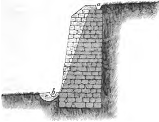
Futtermauer der Rieselanlage Fig. 297.
