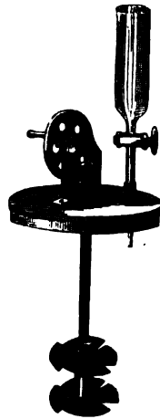
Fig. 8. Lichtdichter Deckel mit Rührvorrichtung.
