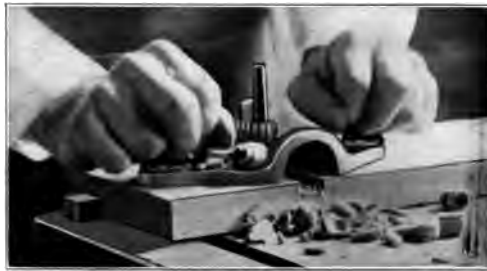
Fig. 122. Using a Router-Plane.
