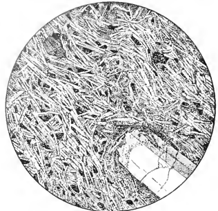
Fig. 6. Sodalith-Trachyt-Ischia. Sanidineinsprengling in fluidaler Grundmasse aus Sanidin leisteichen. Vergrößerung 25.
