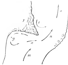
Fig. 3. Gegenströmung an einem Vorsprung. Aus v. Neunmayr, Anleitung zu wissenschaftlichen Beobachtungen auf Reisen.
