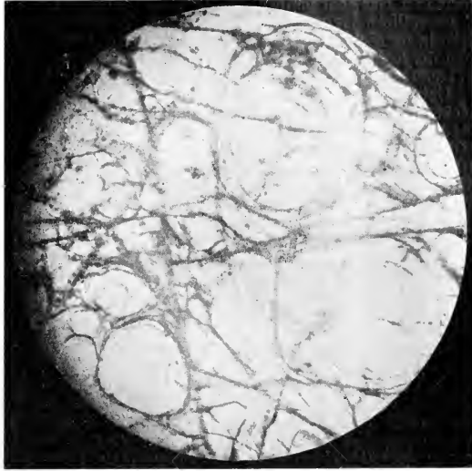
Fig. 6. Perlitpechstein, Ungarn. Kugelige Absonderung. Mikroskopisch.
