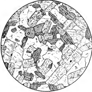
Fig. 1. Biotitgranit. Pulsnitz, Sachsen. Quarz hell, Feldspate trübe, Biotit schraffiert. Vergrößerung 15.
