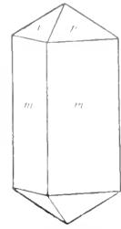
Fig. 17. Zirkon. Tetragonale Pyramide und Prisma I. Art. p = \{111\}, P und m = \{110\} \circ P .
