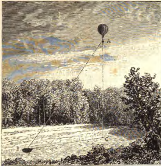
Emploi de l'ombre du ballon pour la vérification de la loi des hauteurs barométriques. ABC triangle-rectangle représenté en perspective. (Page 24.)
