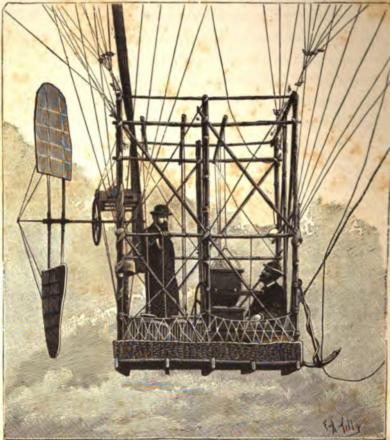
La nacelle du premier aérostat dirigeable électrique, vu de profil. Expérience du 8 Octobre 1883.
