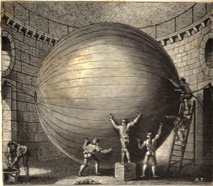
Opération du vernissage d'un ballon à l'ancienne école aérostatique de Meudon, (D'après une aquarelle inédite de Condé). — Page XXII.
