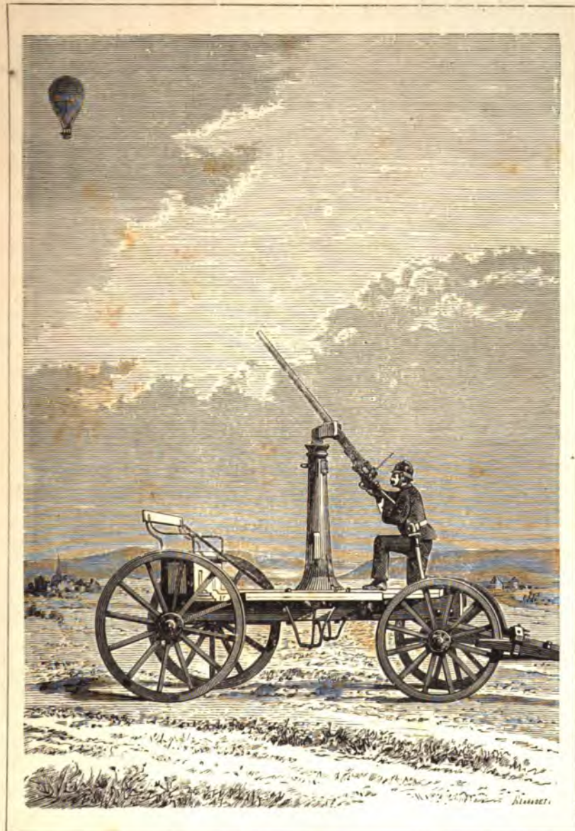
Le mousquet à ballon employé par les Prussiens pendant le siège de Paris, pour tirer sur les aérostats poste (d'après une photographie). (Page 83.)
