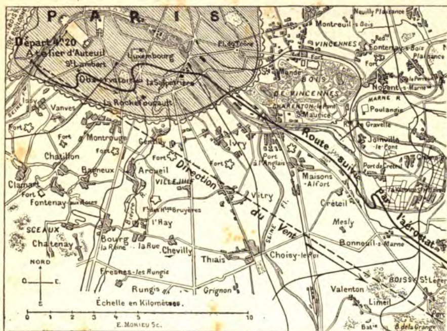
Tracé d'une partie du voyage aérien exécuté par MM. Tissandier frères, le 26 septembre 1884, dans leur aérostat électrique à hélice.
