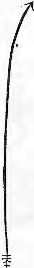
FIG. 9. — Tige de la sonde.
