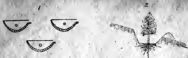
圖24 在 25^{\circ} 以下的坡面上，魚鱗坑內樹木栽植位置圖 1. 平面圖； 2. 栽樹位置圖。
