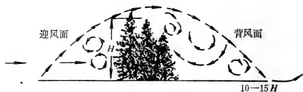
图4-14 稠密防护林对风速的影响和防护面积。(H为障碍物高度) (Van Eimern等, 1964)
