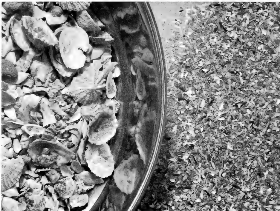
Figura 3. Proceso de cribado de una muestra con una malla de 0,8mm Figure 3. Screening process with a 0.8 mm mesh
