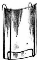
Fig. 3. Gewölbte Glastafel mit Vorrichtung zum Anhängen an den Sack.
