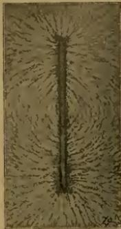
Feilspannbild eines Stabmagneten.
