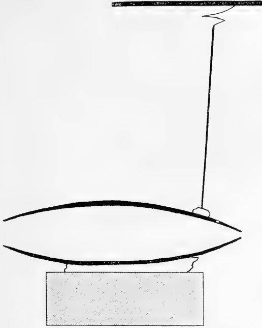
Fig. 3. — Représentation schématique du dispositif employé pour l'inscription graphique des mouvements des valves chez un Acéphale.
