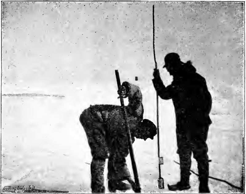
Messung der Temperatur des Eises.
