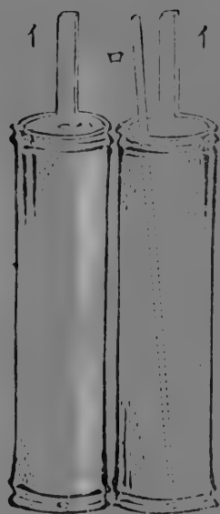
灌油器の圖 (一)は竹筒(ハシ)を拇指にて開閉し只て油を滴注 加減する孔(ニ)は油を滴注する孔
