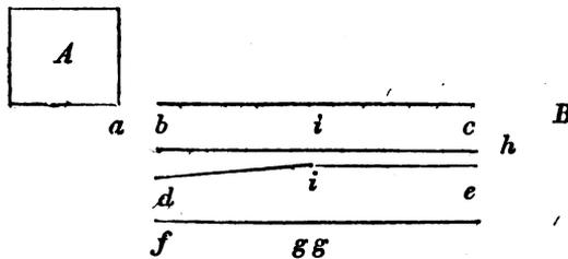
In dieser Figur bezeichnet *A* die Stelle der Zeugbütte, *B* jene des Haspels, welcher das fertige Papier aufnimmt. Die Formwalze befindet sich bei *a*; die beiden endlosen
