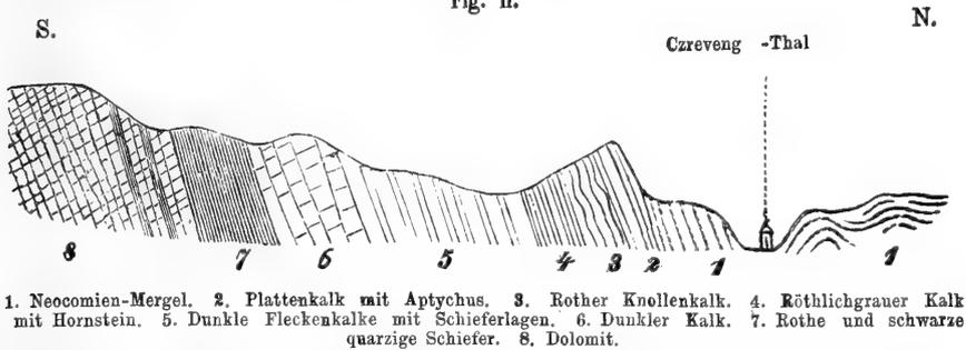
1. Neocomien-Mergel. 2. Plattenkalk mit Aptychus. 3. Rother Knollenkalk. 4. Rötlichgrauer Kalk mit Hornstein. 5. Dunkle Fleckenkalke mit Schieferlagen. 6. Dunkler Kalk. 7. Rothe und schwarze quarzige Schiefer. 8. Dolomit.
