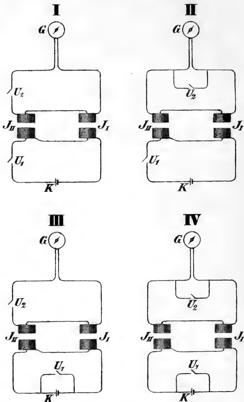
In allen vier Fällen enthält der primäre Kreis die Kette  $K$  für die Stromquelle und die inducirenden Rollen der Inductorien  $J_1$  und  $J_2$ , die zur Inductionswage gehören; in den secundären Kreis sind eingeschaltet
