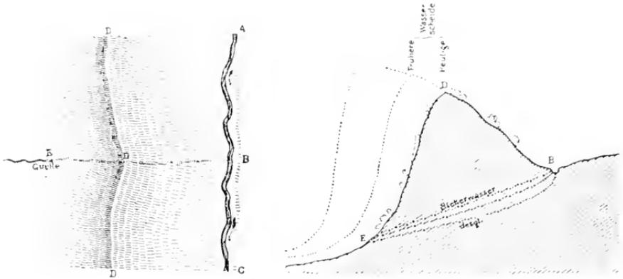
Ein Fluss  $ABC$  laufe ungefähr parallel der Hauptwasserscheide  $DD$ , die steil abfällt und früher weiter entfernt von dem Flusse lag. Mit dem Fortschreiten der Erosion wird die Möglichkeit immer wahrscheinlicher, dass Sickerwasser den Weg  $BE$  finden. Spalten und
