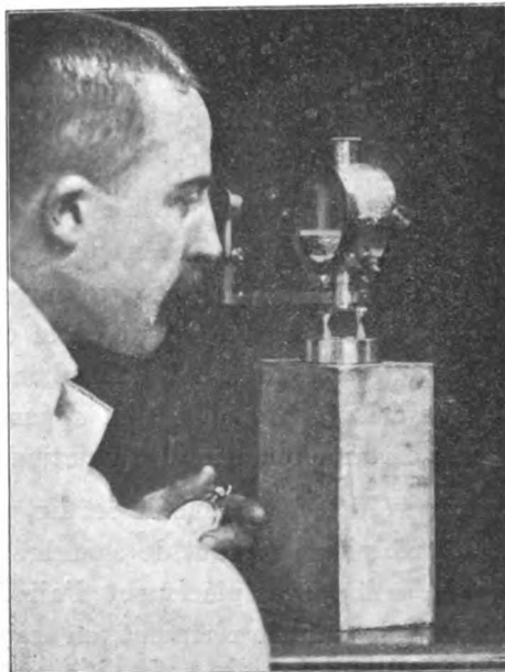
FIG. 6 — L'électroscope chargé, on suit au moyen du microscope la chute des feuilles d'aluminium et on note avec une montre à seconde la durée de cette chute.
