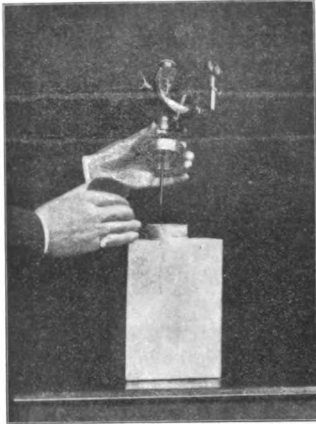
FIG. 5. — On enlève prudemment le bouchon fermant la chambre d'ionisation pleine d'air radioactivé et on le remplace par l'électroscope de Geitel et Elster.
