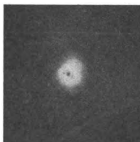
Fig. 3. — Tube Coolidge n° 2. Anticathode parallèle au plan de la plaque. — Grossissement 2. 1 milli. — Etincelle 11 cm. — Pose 1 minute. — Dimensions de l'impact: 5^{mm} \times 5^{mm},5 .
