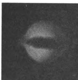
Fig. 30. — Tube Pilon renversé. 2 milli. — Etincelle 14 cm. Pose 10 minutes. Support du tube placé du côté de la cathode.
