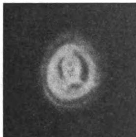
Fig. 2. — Tube Coolidge. Anticathode parallèle au plan de la plaque. 2 milli. — Etincelle équivalente 10 cm., pose 1 minute. — Grossissement 2. — Dimensions réelles de l'impact 9,5 \times 10,5 .
