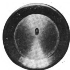
Fig. 8. — Anticathode d'un tube Drissler. — Zone d'impact produite par une seule décharge d'un transformateur de 8 K W A (grandeur nature).
