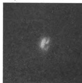
Fig. 4. — Tube Coolidge n° 3. Anticathode parallèle au plan de la plaque. — Grossissement 2. 1 milli. — Etincelle 11 cm. — Pose 1 minute. — Dimensions de l'impact: 4^{mm} \times 2^{mm},5 .
