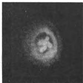
Fig. 5. — Tube Coolidge n° 1. Fig. 6. — Tube Coolidge n° 2. Fig. 7. — Tube Coolidge n° 3. Mêmes conditions de fonctionnement que précédemment. — Grossissement 2. (L'anticathode est inclinée à 45^\circ . — Position habituelle).
