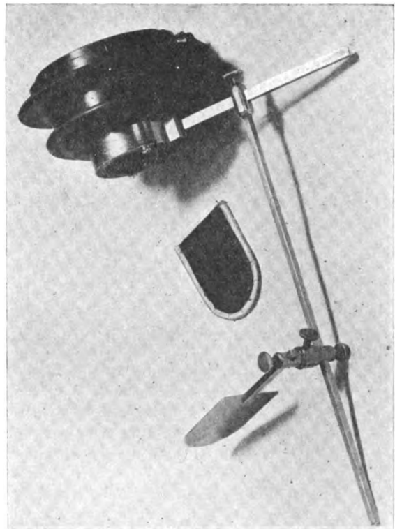
Le porte-film et le support se montant sur la cupule.
