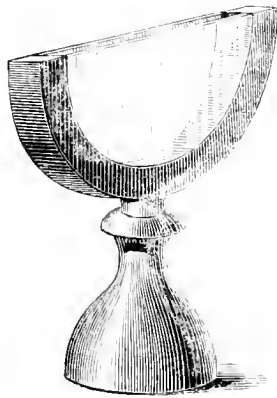
Fig. 16. — Eprouvette du galactomètre de M. Vogel.
