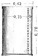
Fig. 13. — Coupe verticale d'une fosse mobile du système divisé de la compagnie chauxfournière de l'Ouest.
