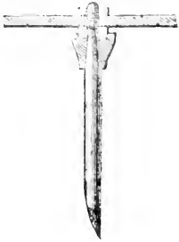
Fig. 28. — Dent de la herse articulée de M. Hidien.
