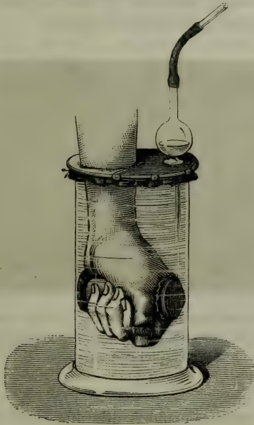
FIG. 1. — Appareil explorateur des changements du volume de la main. — La membrane au travers de laquelle passe l'avant-bras est immobilisée par une plaque métallique; dans le tube vertical muni d'une ampoule, s'opèrent les changements de niveau qui s'inscrivent à distance à l'aide de la transmission par l'air.
