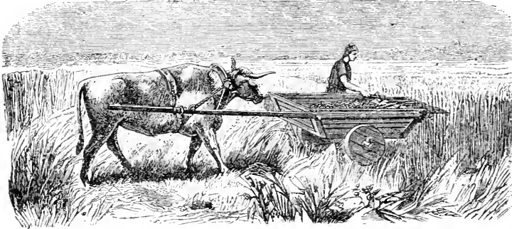
Fig. 102. Gammal gallisk skördemaskin, enligt beskrifning af Palladius.
