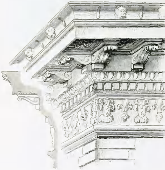
Abb. 227. Kranzgesims des Palazzo Farnese in Rom.
